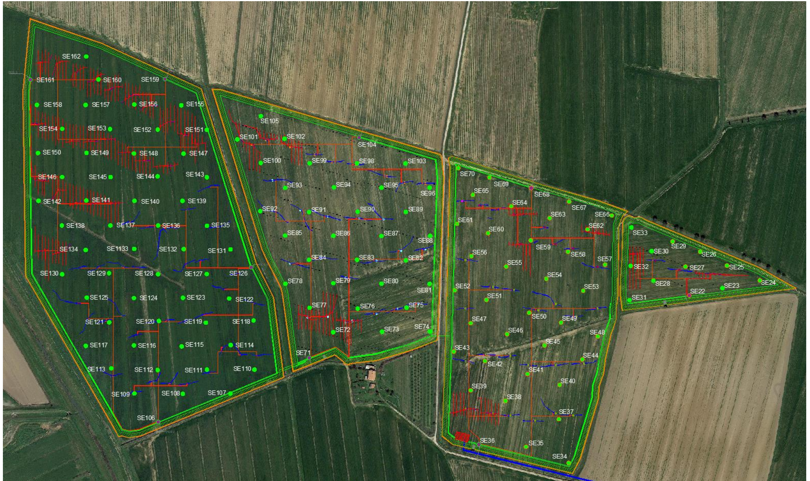
Figura 22 – Campo agrivoltatico: Ubicazione saggi esplorativi (SE22+SE162). ● saggi esplorativi, ● saggi esplorativi (trasformatori)
