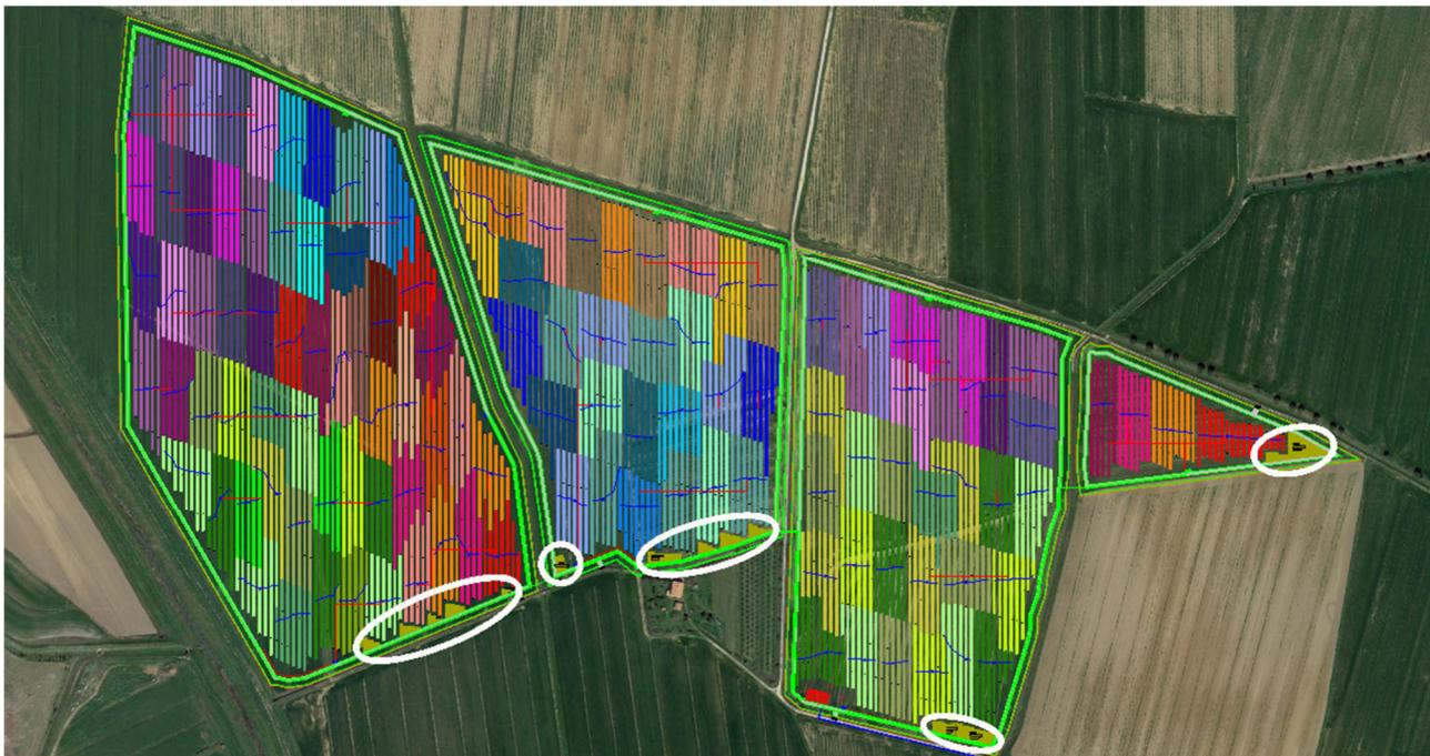
**Figura 18** Planimetria con ubicazione delle aree tecniche di cantiere per l'impianto agrivoltaico
