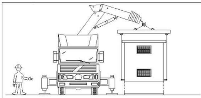
Le caratteristiche della cabina monoblocco consentono la recuperabilità integrale del manufatto con possibilità di poterla spostare e riutilizzare in altro luogo.
