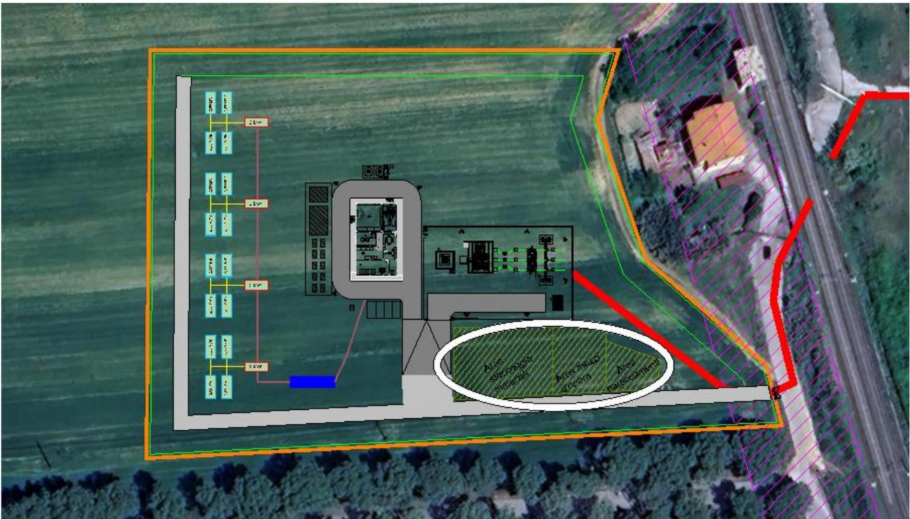
**Figura 7-10 Planimetria con ubicazione delle aree tecniche di cantiere per l'impianto BESS**
