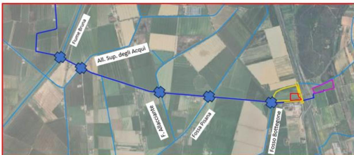
La realizzazione del cavidotto è prevista in affiancamento a viabilità esistente.
