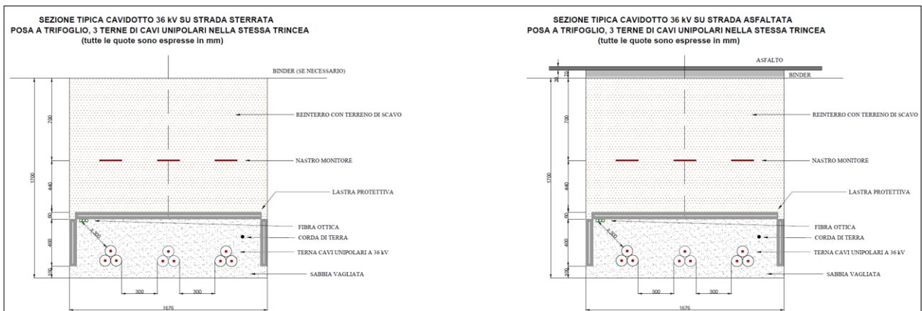
**Figura 2.3.2.5:** Sezioni tipiche delle trincee cavidotto per tre terne di cavi in parallelo su strada sterrata e asfaltata
