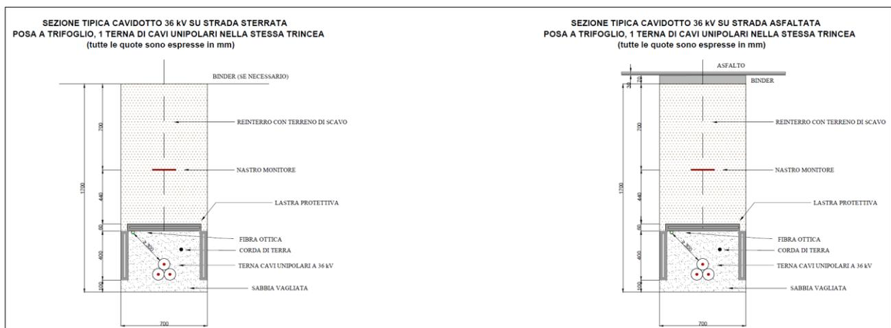
**Figura 8.1:** Sezioni tipiche delle trincee cavidotto per una terna di cavi su strada sterrata e asfaltata
