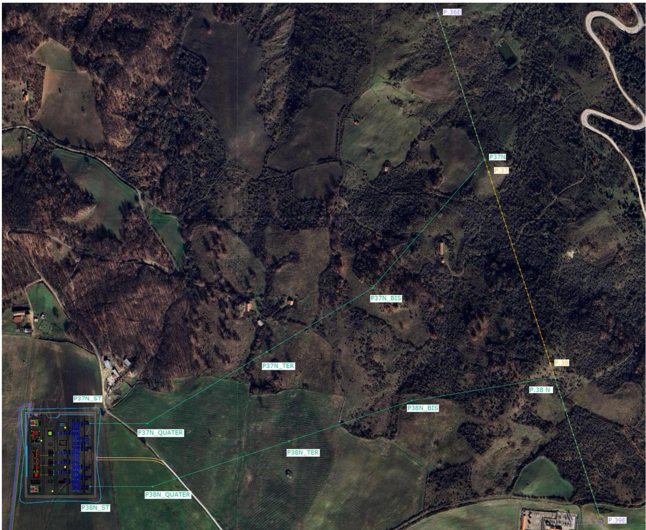
**Figura 7.1:** Planimetria su base ortofoto dei nuovi raccordi aerei entra – esce a 150 kV, del tratto di linea aerea esistente a 150 kV, del tratto aereo da demolire a 150 kV e relativi sostegni
