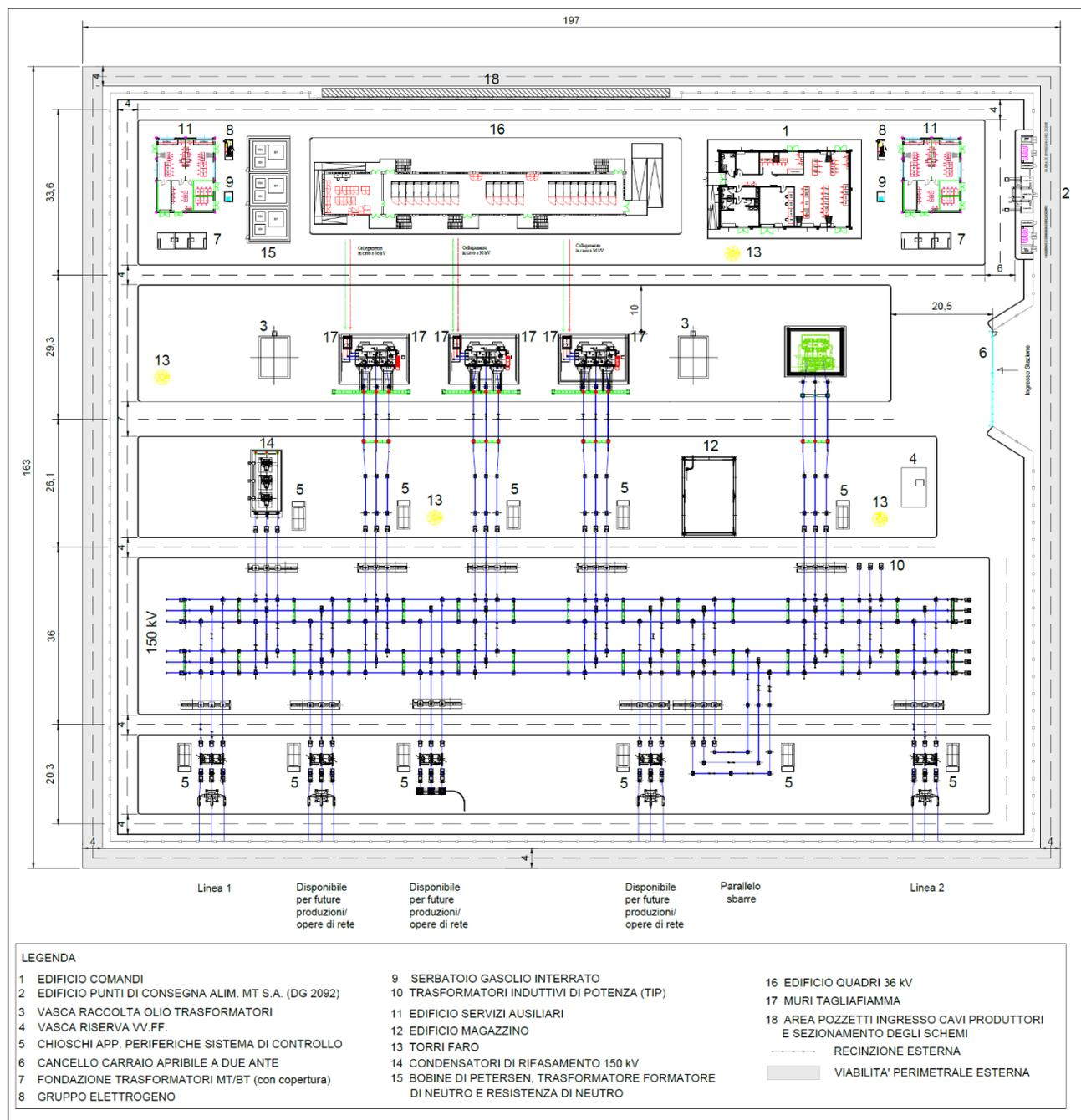
**Figura 6.2.1:** Planimetria elettromeccanica della SE RTN Terna 150/36 kV
