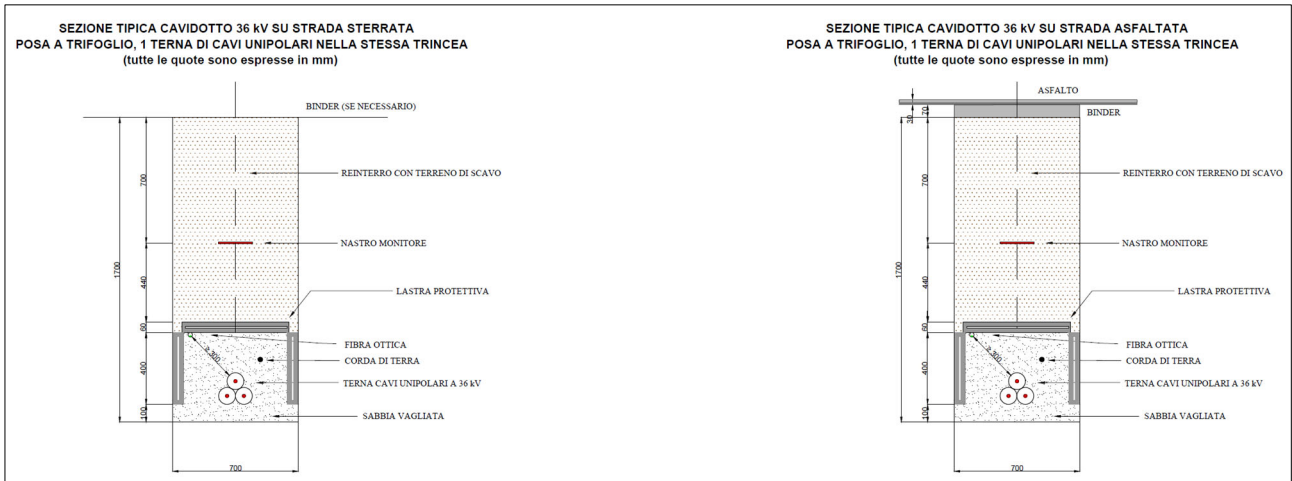
Figura 3.3.1: Sezioni tipiche delle trincee cavidotto per una terna di cavi su strada sterrata e asfaltata
