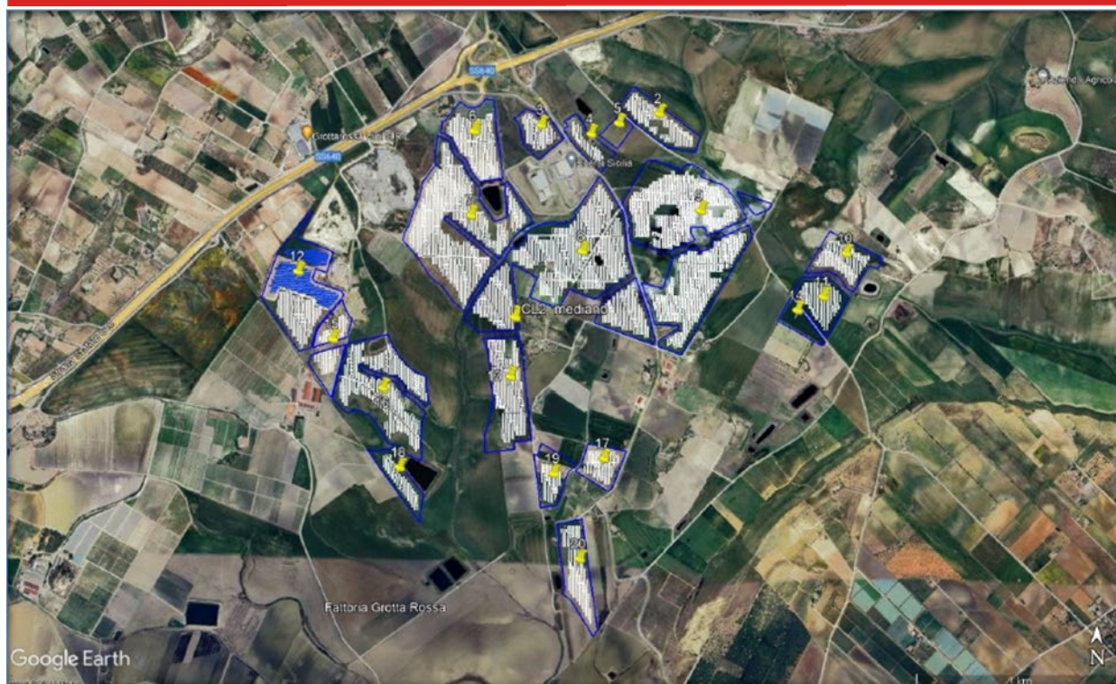
Figura 7-10: Layout dell'impianto: stralcio ortofoto con indicazione delle stringhe fotovoltaiche e del punto mediano
