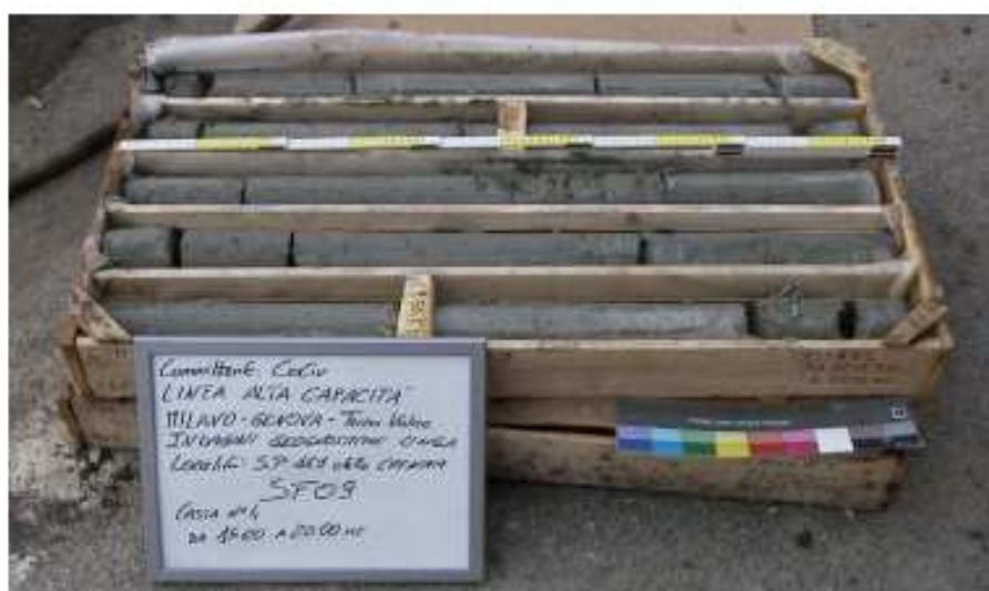
Figura 4-11:- Strato degradato marne – substrato marnoso SF9
