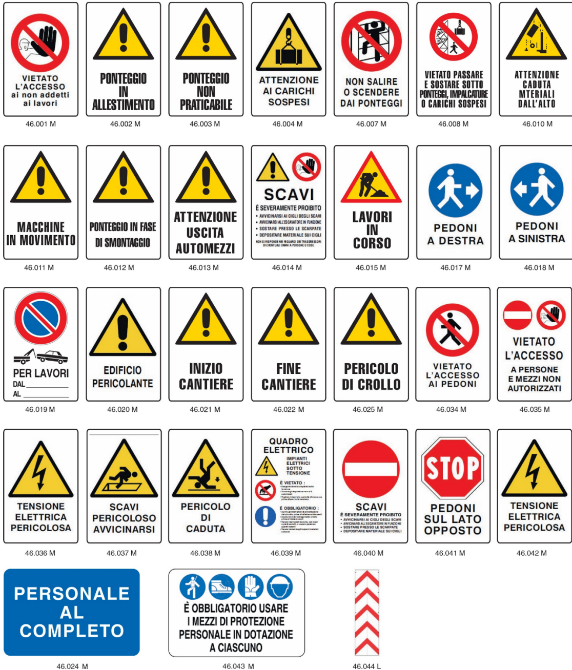
Figura 16-1: Segnaletica Generale prevista nel cantiere.
