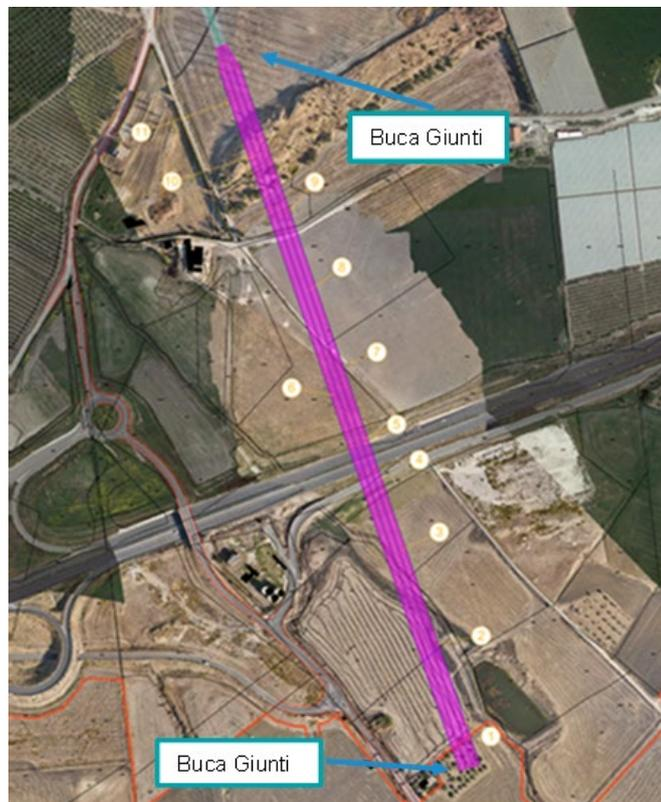
**Figura 4-8: Dettaglio tracciato elettrodotto a 36kV, aree buche giunti.**
