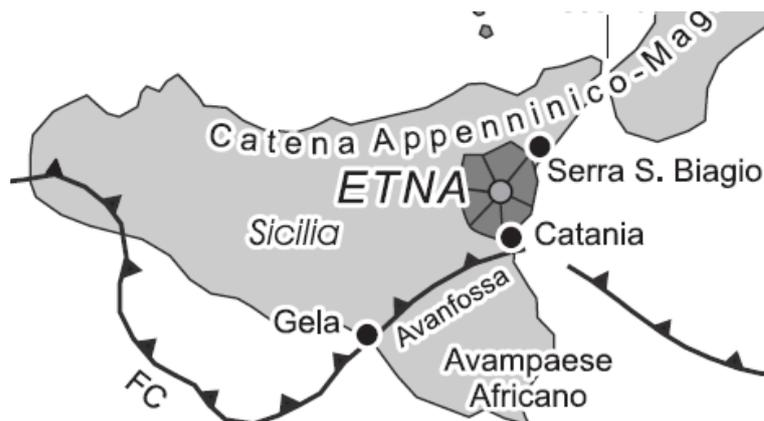
Figura 3-22: Schema strutturale della Sicilia e della Calabria (Fonte: LANZAFAME ET ALII 1999, Fig. 1).
