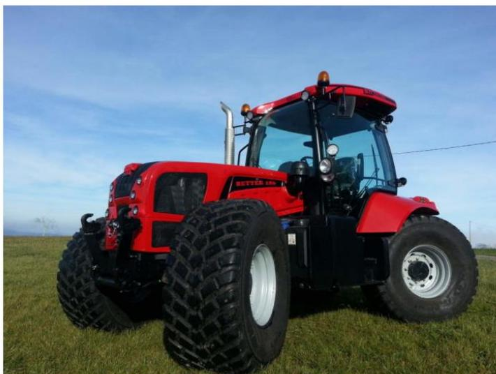
Esempio di trattore con gomme anti-compattamento per evitare la costipazione del terreno
