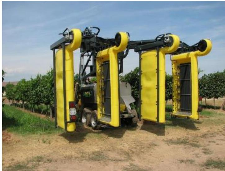
atomizzatore per pareti continui con barre per il recupero della deriva dei prodotti fitosanitari.
