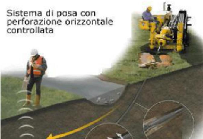
Sistema di trivellazione orizzontale controllata (T.O.C.)
