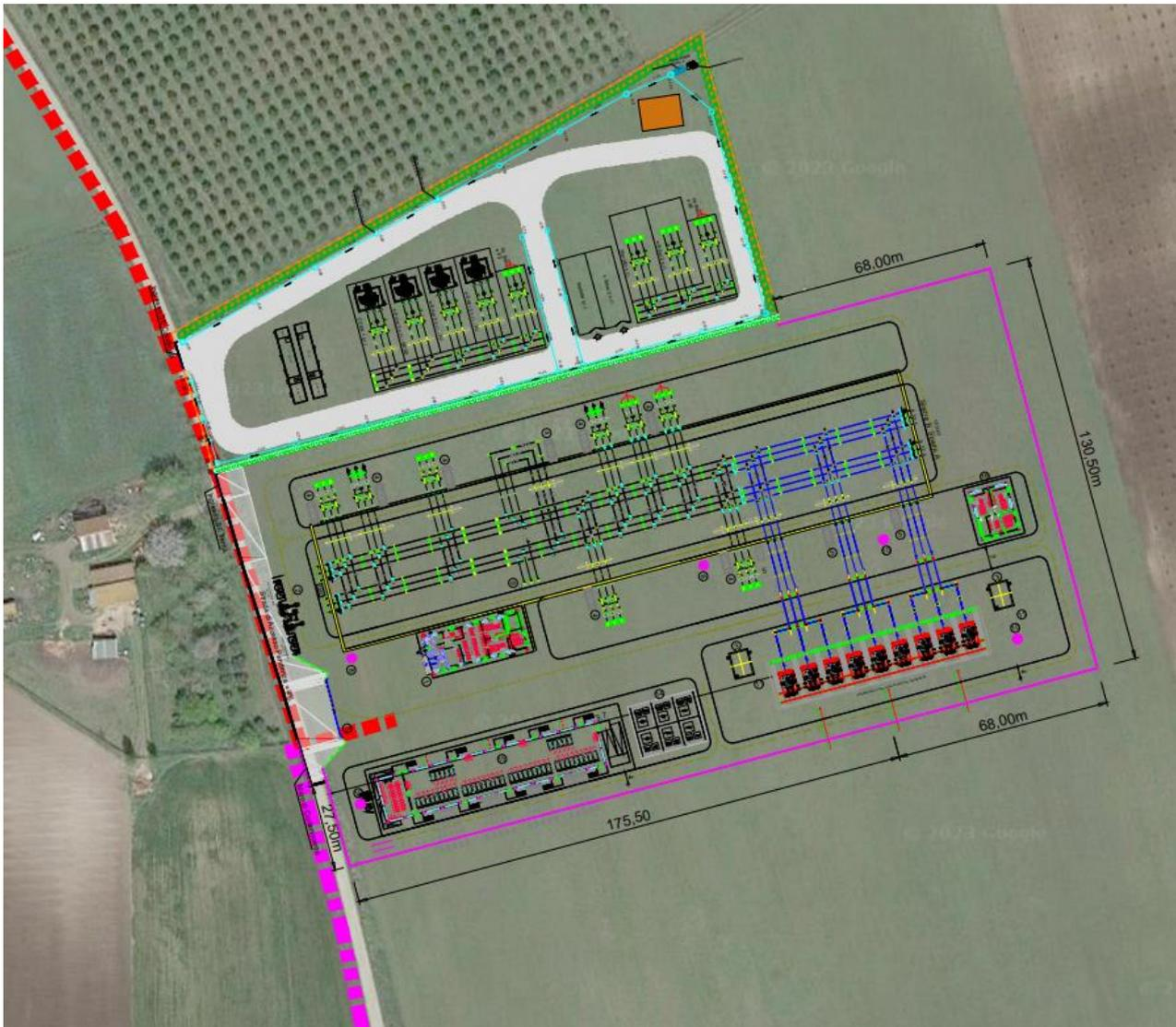
FIGURA – SE TERNA 150/36 kV (LA CUI SEZIONE A 36 kV [IN BLU] NON È STATA ANCORA BENESTARIATA DA TERNA)
