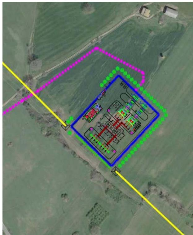
FIGURA– NUOVA STAZIONE ELETTRICA DI TRASFORMAZIONE A 380/150 kV DELLA RTN E RACCORDI PER L'INSERIMENTO IN ENTRA/ESCE ALLA LINEA A 380 kV DELLA RTN "ROMA NORD – PIAN DELLA SPERANZA" (GIÀ BENESTARIATA DA TERNA ED AUTORIZZATA DALLA REGIONE LAZIO)
