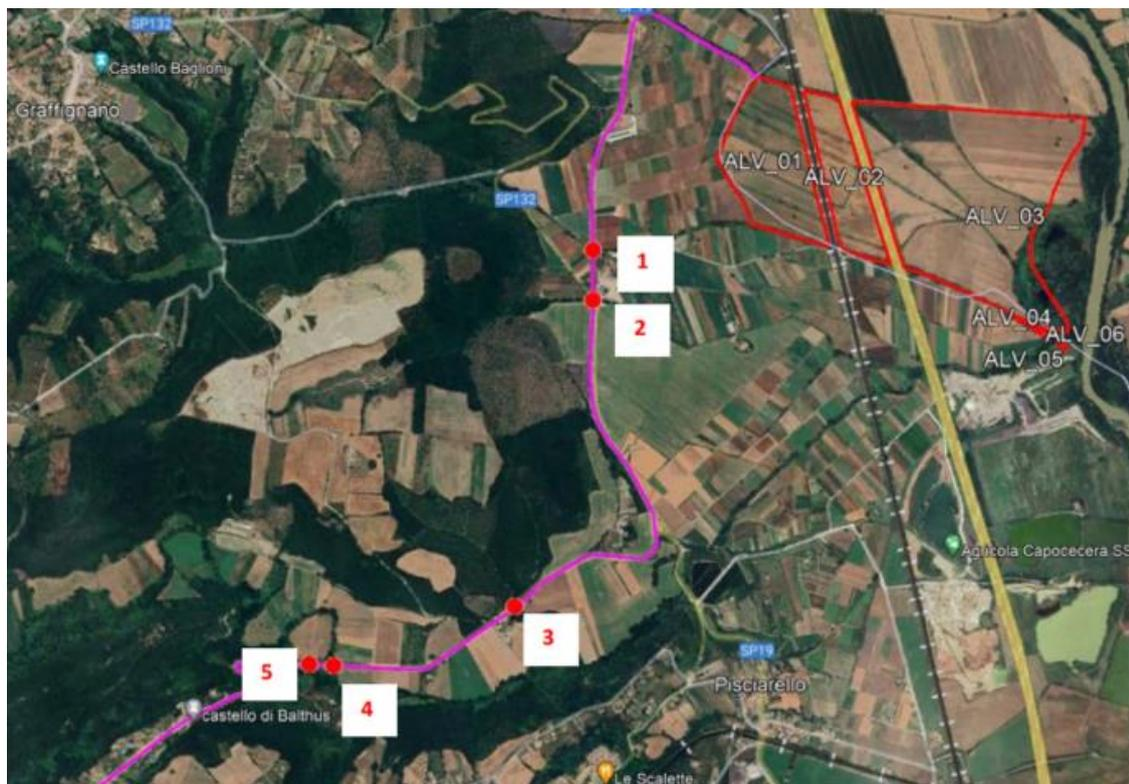
**FIGURA 31 – Interferenze cavidotto MT (in viola) con il reticolo idraulico**
