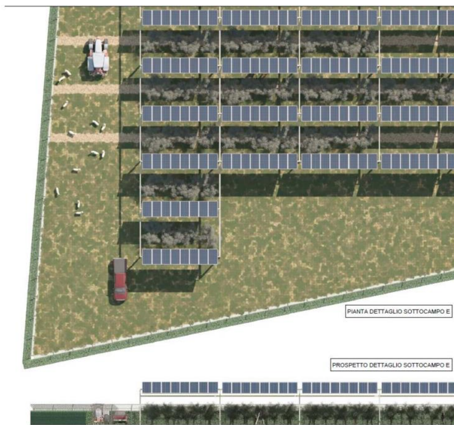
Figura - Vista Planimetrica dell'impianto agrivoltaico
