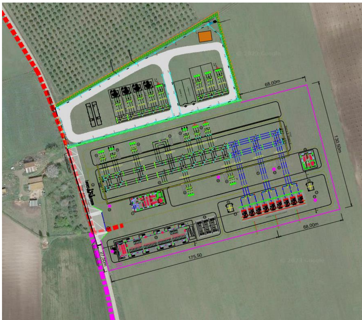
FIGURA – SE TERNA 150/36 kV (LA CUI SEZIONE A 36 kV [IN BLU] NON È STATA ANCORA BENESTARIATA DA TERNA)
