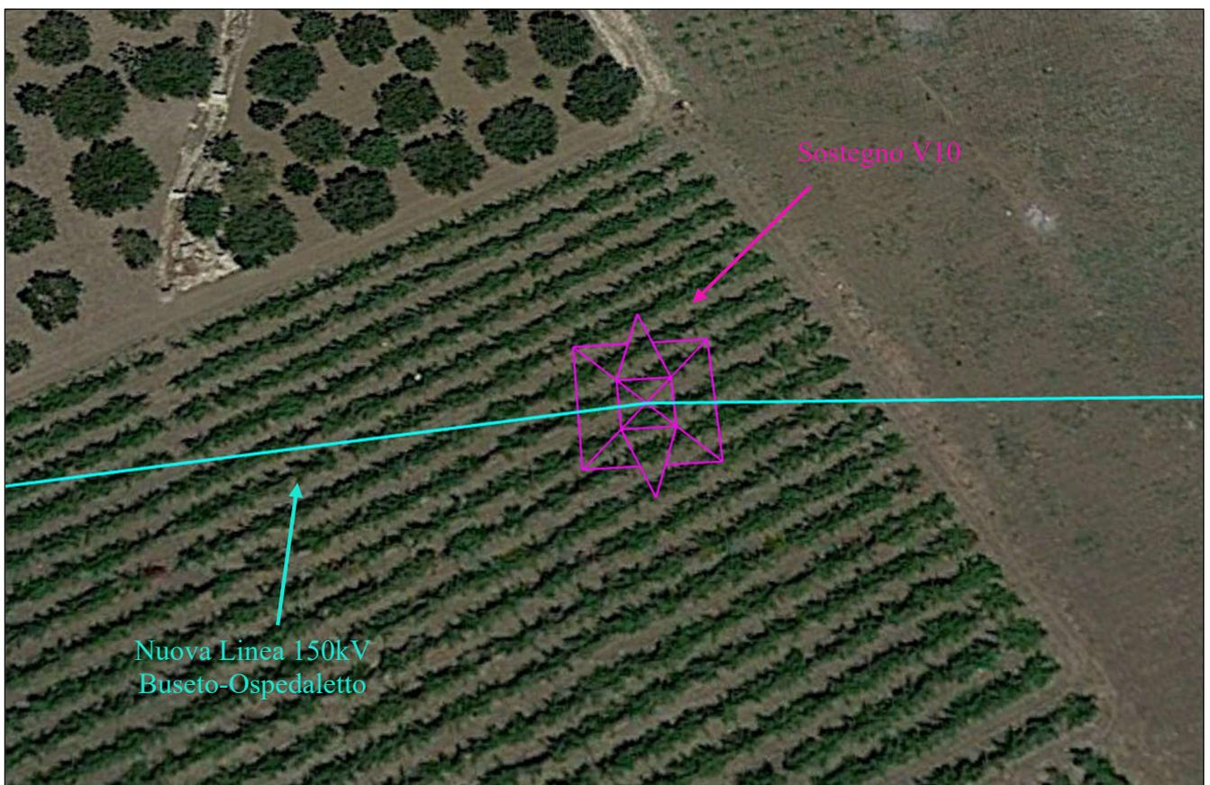
Figura 25. Traliccio vertice di sostegno V10 del nuovo elettrodotto 150kV su area a vigneto.
