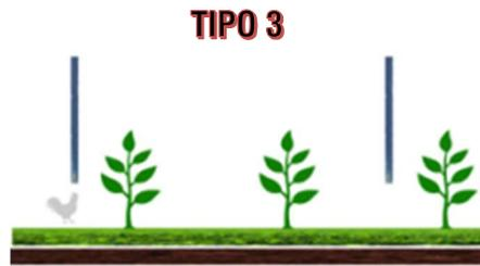
Figura 31. Sistema agrivoltaico in cui i moduli fotovoltaici sono disposti verticalmente. La coltivazione avviene tra le file dei moduli fotovoltaici, l'altezza minima dei moduli da terra influenza il possibile passaggio di animali
