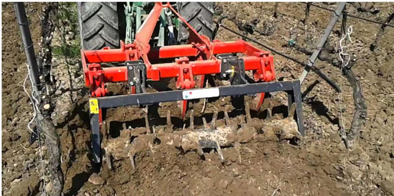
*Figura 45. Esempio di ripuntatore interfilare su trattore gommato, in vigneto.*
