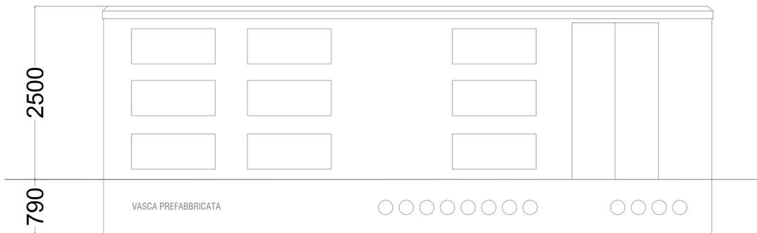
PROSPETTO LATERALE DELLA CABINA PREFABBRICATA DI TRASFORMAZIONE
