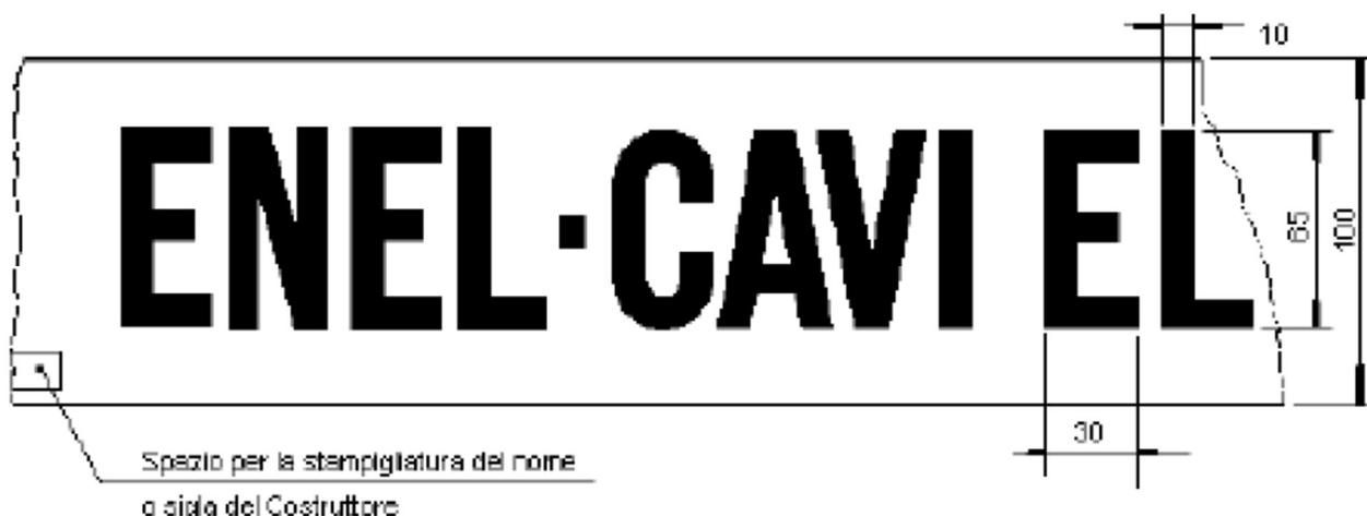
Figura 8: Esempio di nastro segnalatore cavi elettrici con caratteristiche dimensionali
