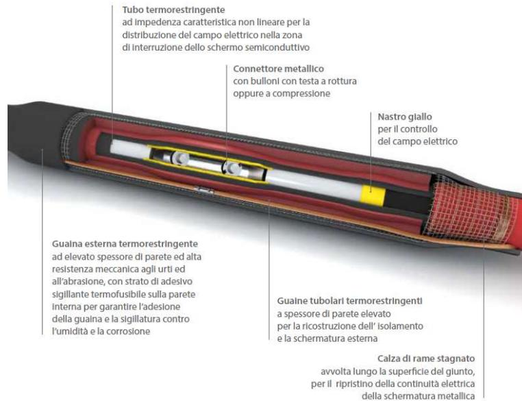
Figura 13. Esempio di giunto per cavo a 20 kV
