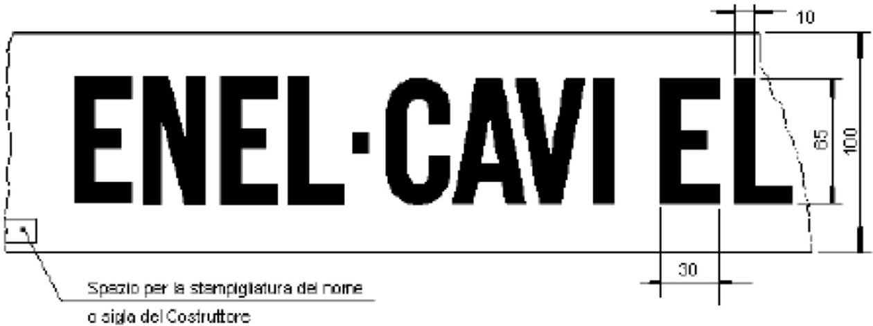
Figura 11: Esempio di nastro segnalatore cavi elettrici con caratteristiche dimensionali
