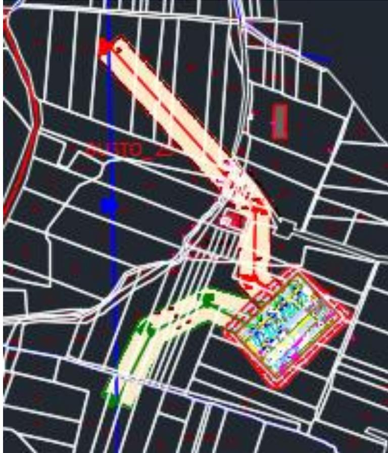
**Figura 1:** Schema di connessione alla RTN della Futura SE di trasformazione Buseto 2 150/36kV con entra-esce della Linea DT 150 kV “Buseto Palizzolo–Fulgatore” e “Buseto Palizzolo–Castellammare Golfo”
