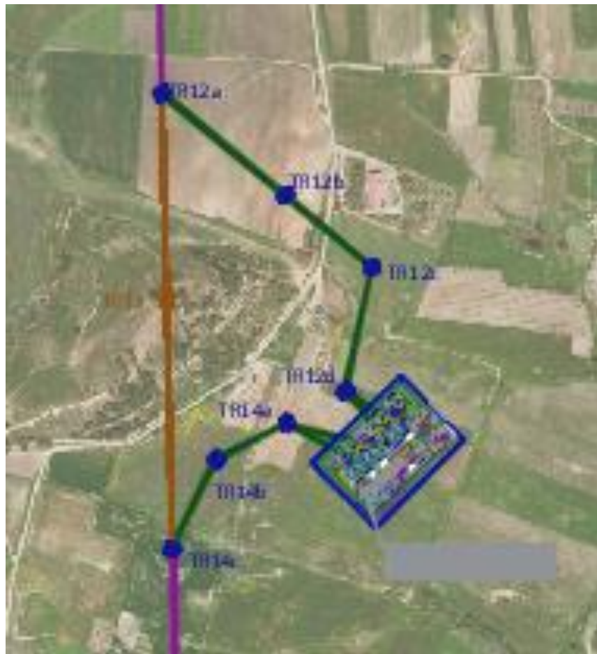
Figura 2: Inquadramento dei raccordi della nuova SE "Buseto 2" alla linea DT 150 kV "Buseto-Fulgatore" e "Buseto-Castellammare del Golfo"
