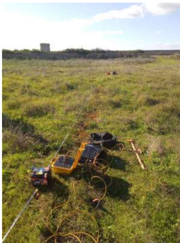
FOTO 2A: postazione di energizzazione SS2
