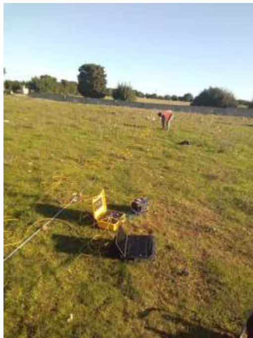
FOTO 1A: postazione di energizzazione SS1
