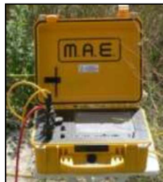
Fig. 2: sismografo multicanale M.A.E. modello A 6000 S.
