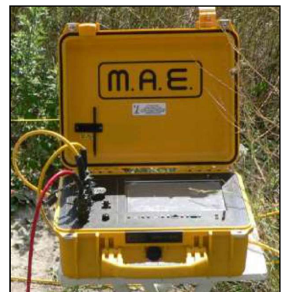
Fig. 3: sismografo multicanale M.A.E. modello A 6000 S.
