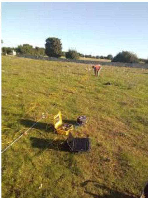
FOTO 1A: postazione di energizzazione SS1
