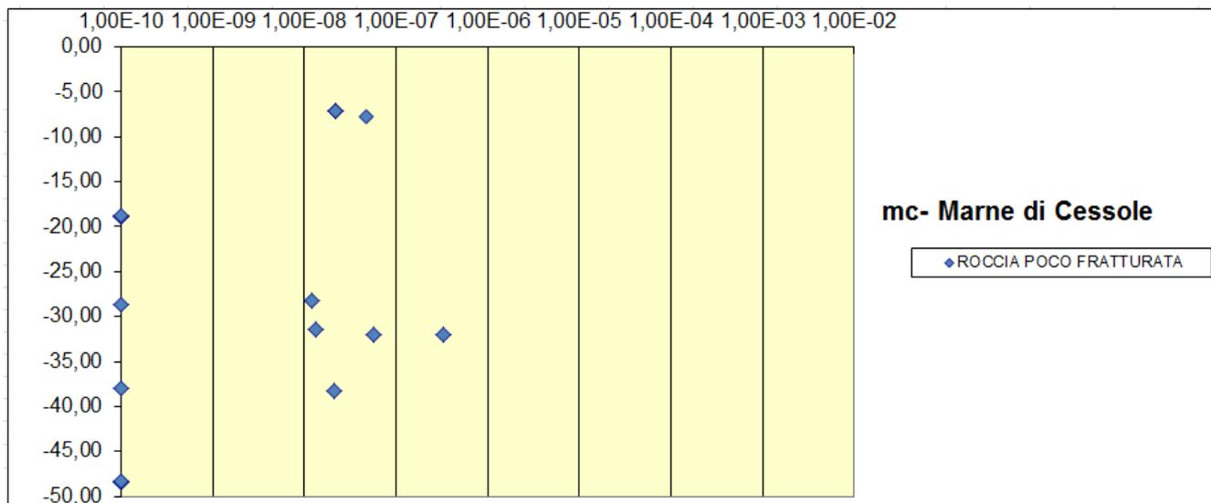
**Figura 2 - Distribuzione dei valori di permeabilità ottenuti da prove in foro per la formazione delle Marne di Cessole (mC), secondo la profondità (i valori pari a  $1E-10$  sono stati attribuiti indicativamente alle prove con assorbimento nullo, per significare che l'ammasso roccioso ha permeabilità molto bassa, comunque inquadrabile nella classe AFTES minore, con  $K < 1E-8$ ).**
