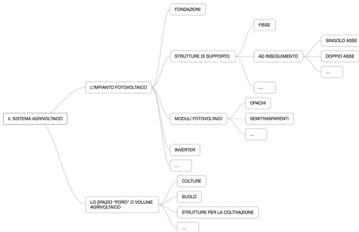
Figura 4. Le varie parti che compongono il "Sistema agrivoltaico" e che quindi concorrono alla composizione della S_{tot} . Tratto dalle Linee guida.
