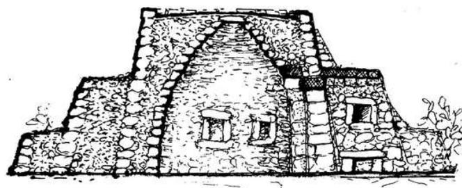
Figura 7. Sezione di un edificio a tholos a tronco di cono. Sono visibili i gradoni inferiori che servono a contenere la spinta della pseudovolta. Tratto dal testo "Le costruzioni in pietra a secco nel Salento leccese" di A. Costantini.
