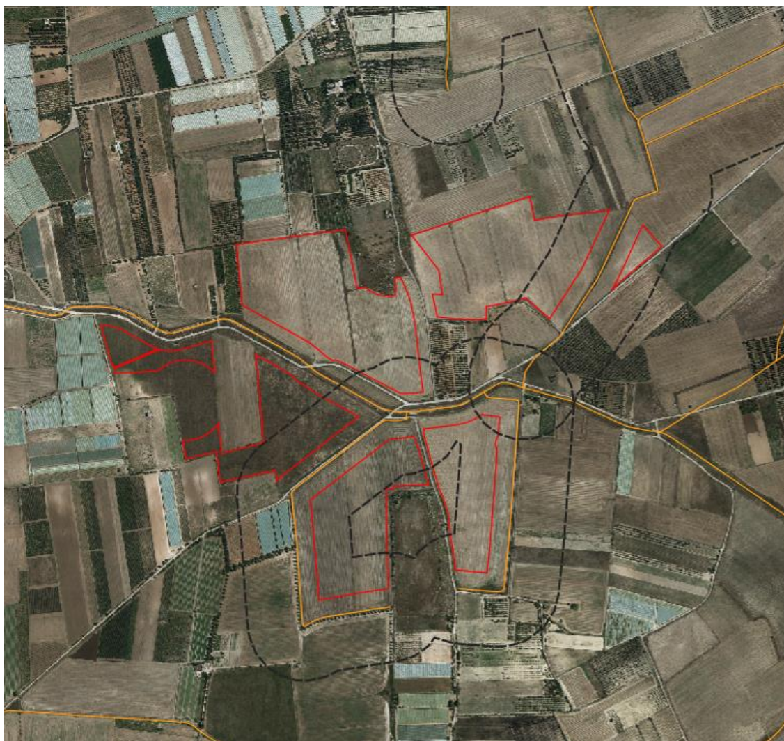
Fig. 6.2 – Buffer 150 m rispetto alle linee di impluvio per le quali il PAI non individua le aree di esondazione
