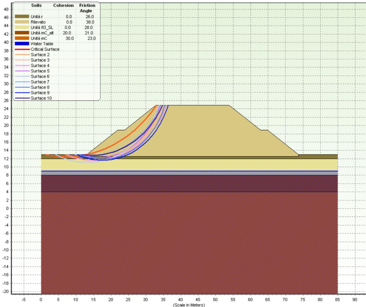
**Figura 5-4 RI1C – Verifica di stabilità globale condizioni sismiche sezione pk 29+024.25**
