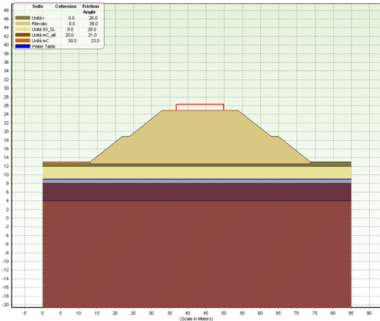
Figura 5-2 RI1C – Geometria della sezione di calcolo pk 29+024.25
