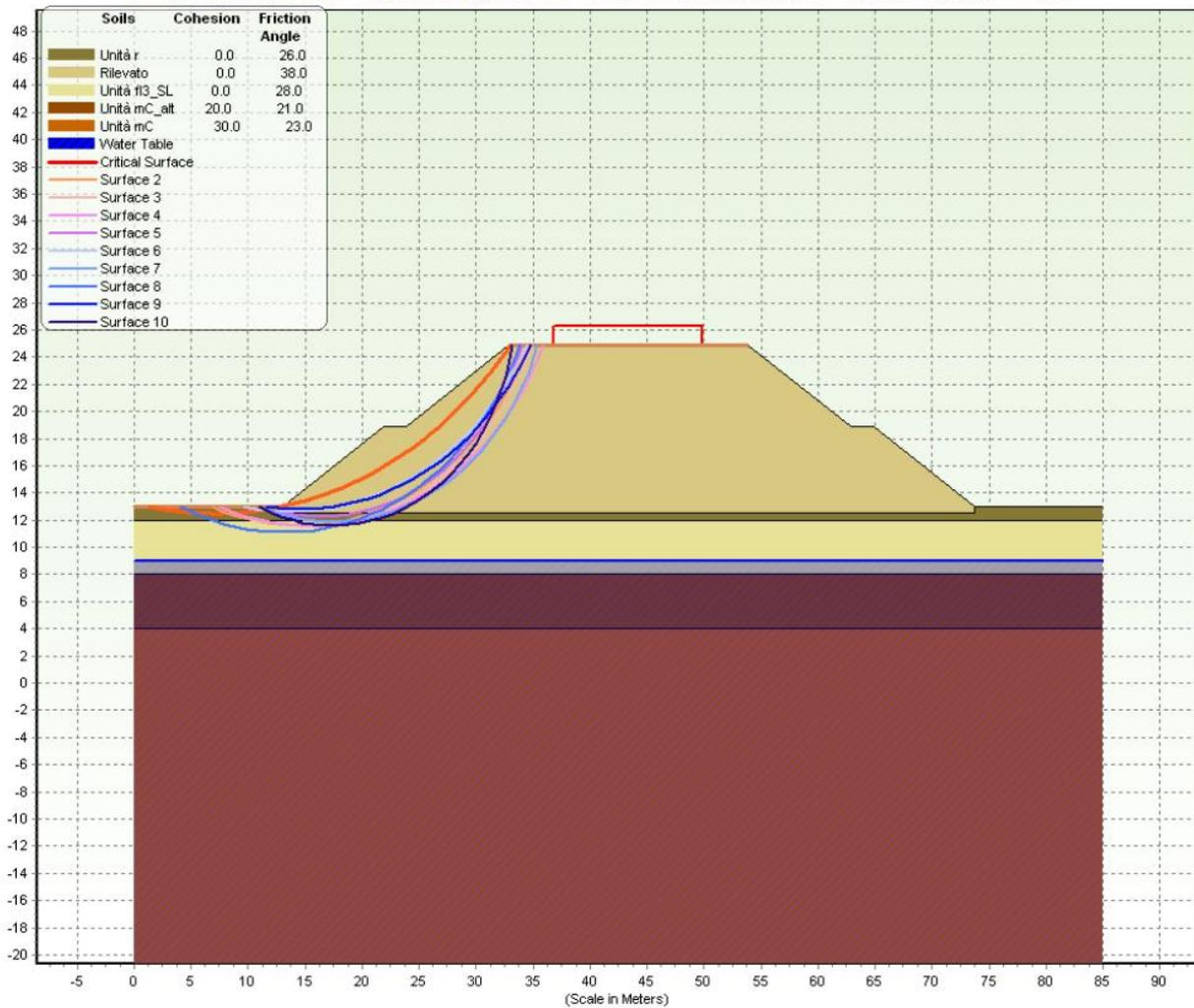
**Figura 5-3 R11C – Verifica di stabilità globale condizioni statiche sezione pk 29+024.25**
