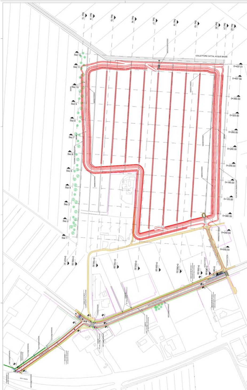
Figura 4. Intervento MP.01: Bacino di laminazione del Canale Acque Medie Cattal. Immagine estratta dal progetto esecutivo dell'intervento.
