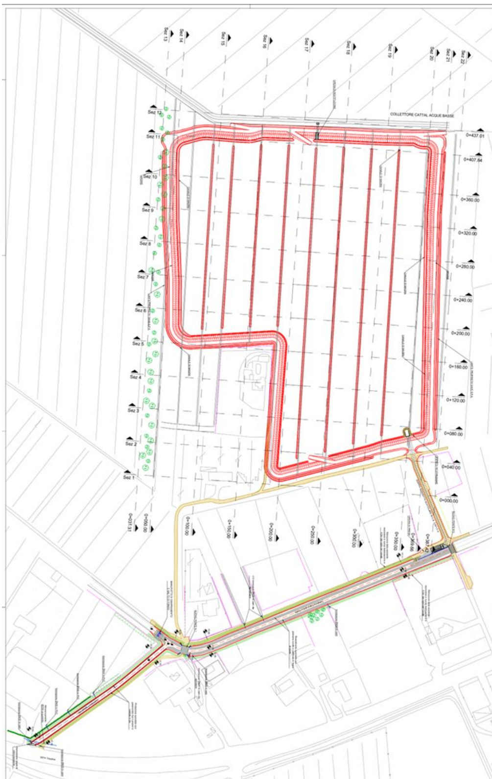
Figura 15. Bacino di laminazione del Canale Acque Medie Cattal - Intervento MP01. Immagine estratta dal progetto esecutivo dell'intervento
