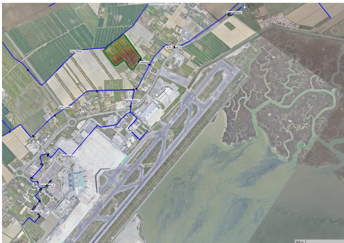
Figura 18. Rete implementata nel modello HEC-RAS – Scenario 3 “2037 con idrovora” (la cassa di laminazione è perimetrata in verde). Immagine estratta da Ras Mapper.
