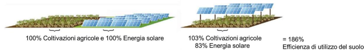
**Figura 3-3 Un'illustrazione dell'incremento di efficienza nell'uso di suolo con fotovoltaico e coltivazioni, basato sul sito test di Heggelbach. © Fraunhofer ISE**
