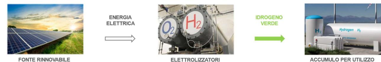
Figura 3-23 Illustrazione del meccanismo di produzione di idrogeno verde
