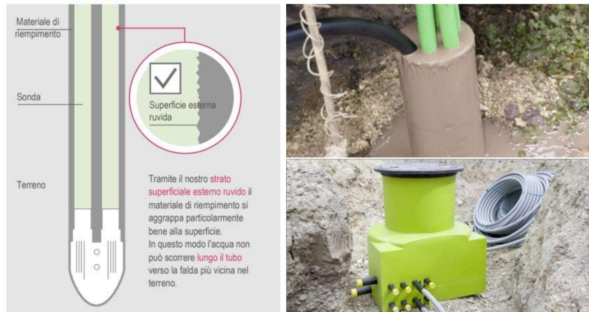
Figura 3-17 Involucro impermeabile sonda geotermica a U e sistema di collettamento
