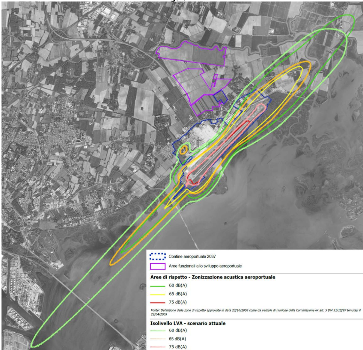
Estratto tavola SIA-RU-CT-10, Livelli di rumore aeronautico – Scenario di progetto – LVA senza ground con zonizzazione aeroportuale
