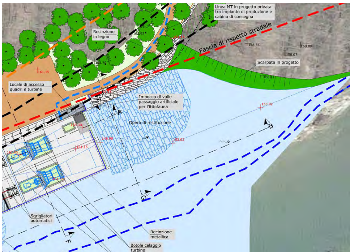
Figura 10: Pianta dell'opera di restituzione
