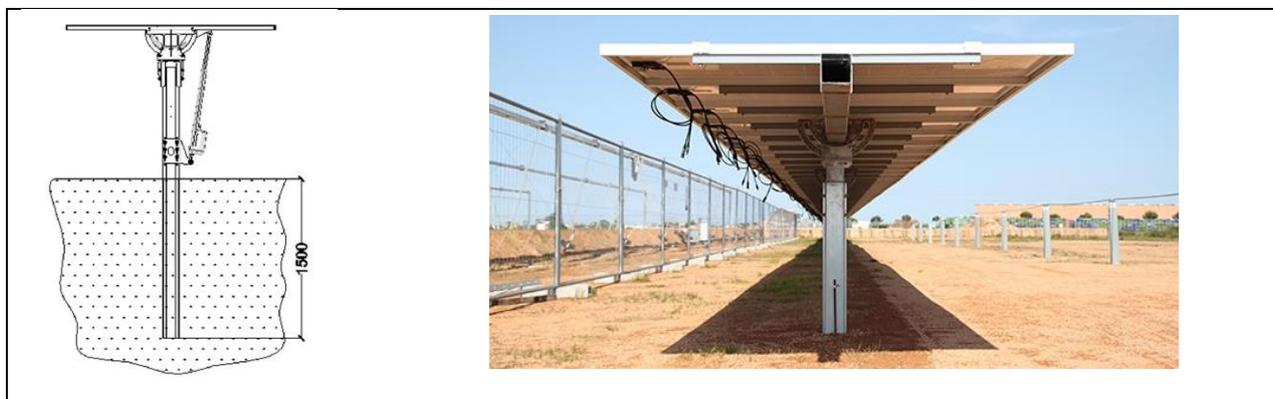
Figura 23 Infissione tipo del palo del tracker nel terreno
