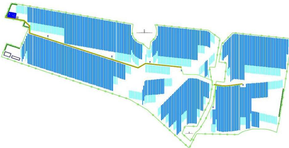
Complessivamente verranno quindi installati 82.516 moduli da 0,695kW per una potenza d'impianto di 57.348,62 kW DC.
