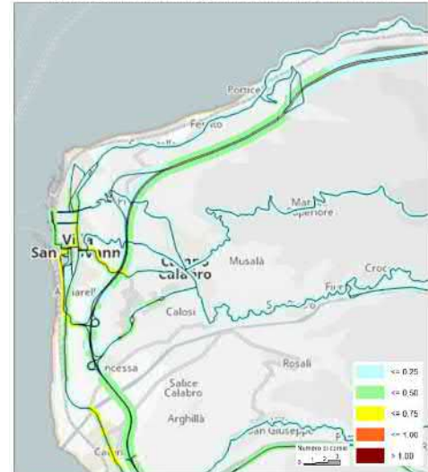
Figura 3-15 Livelli di servizio nell'ora di punta sulla rete stradale di Villa San Giovanni
