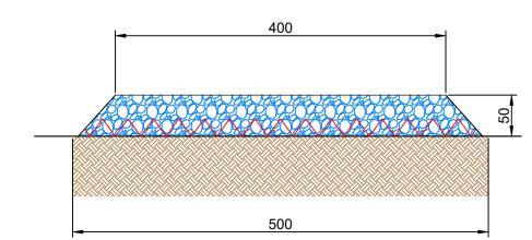
FORMAZIONE DELLA MASSICCIATA STRADALE SOPRA AL PIANO CAMPAGNA COSTITUITA DA STABILIZZATO DI CAVA DI PEZZATURA 40/70
