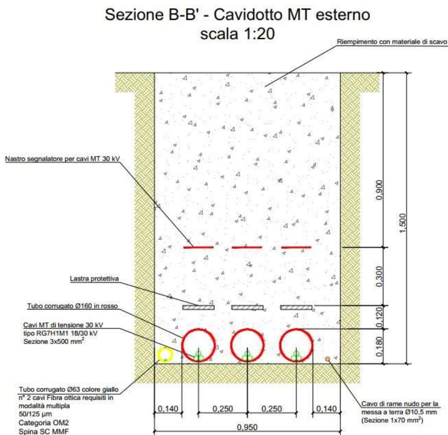
Sezione tipo scavo cavidotto in scala 1:20 nell'originale
