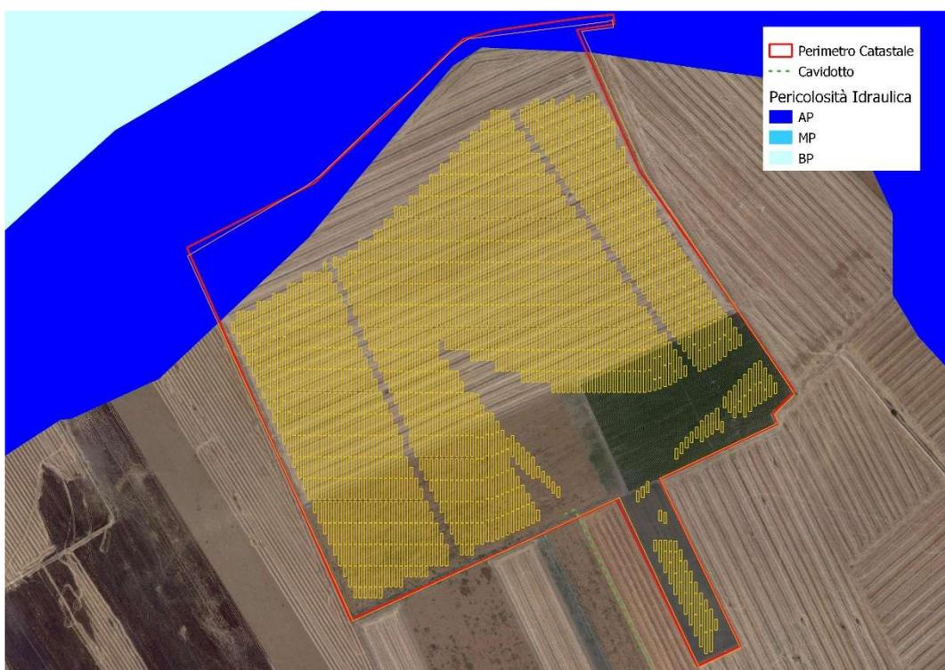
Ubicazione dei moduli fotovoltaici in riferimento alle perimetrazioni di pericolosità idraulica. Tutte le aree interessate dalle perimetrazioni di pericolosità sono state stralciate dalla superficie utile dell'impianto. Seguono ulteriori immagini.
