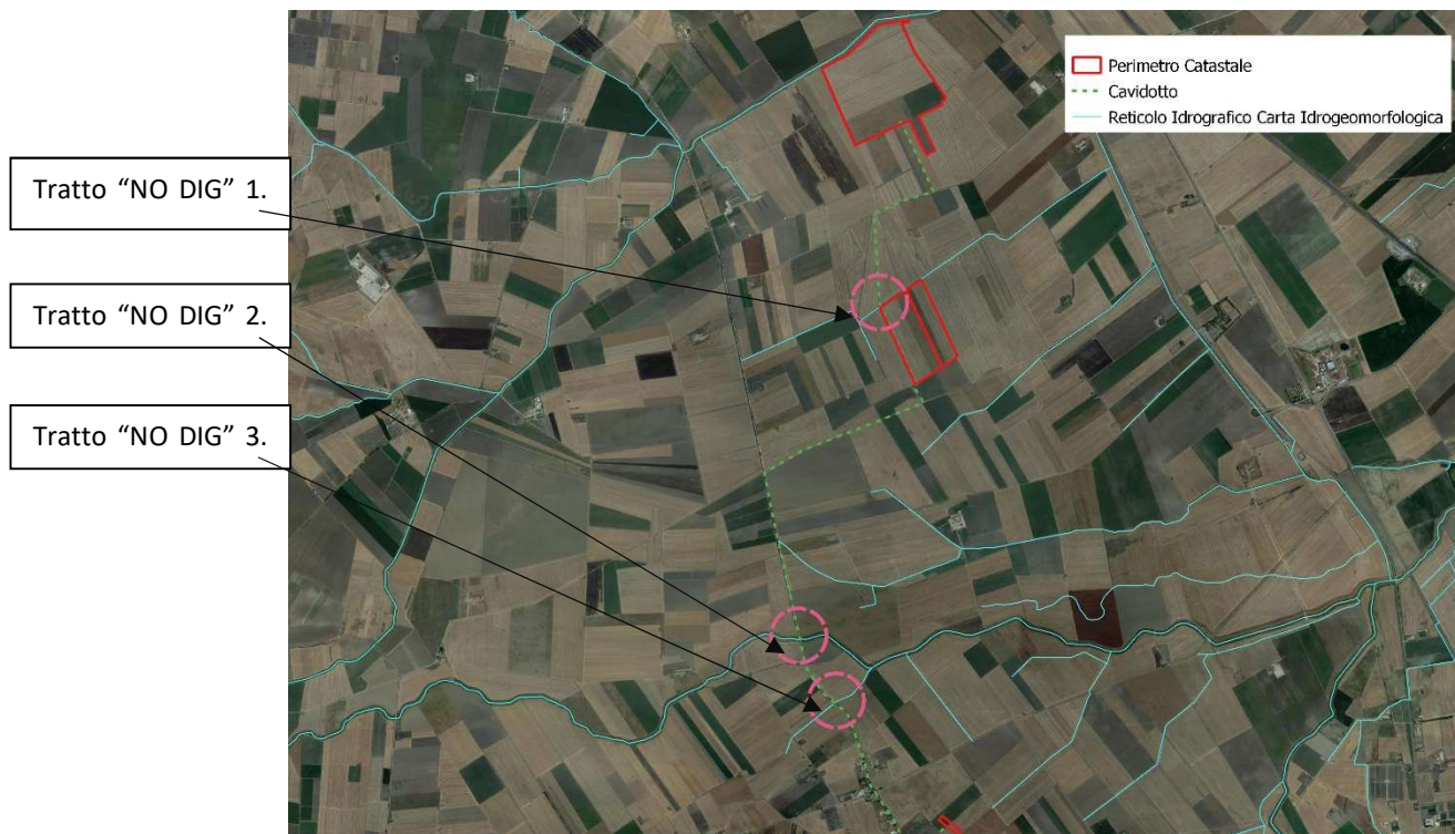
Indicazione dei tratti di cavidotto con posa in opera mediante metodologia "No Dig" su rappresentazione cartografica del reticolo idrografico della Carta Idrogeomorfologica della Puglia
