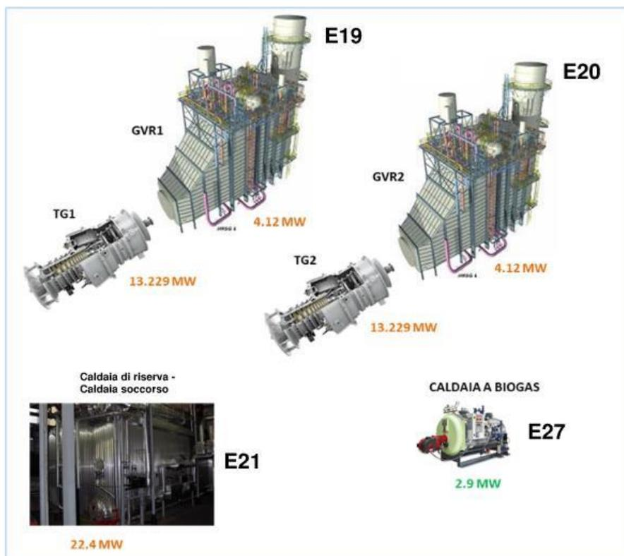
**Figura 26 - Rappresentazione esemplificata degli impianti di combustione e produzione energetica (anche di riserva e/o in stand-by) autorizzati dello stabilimento di Casteggio nella situazione "ex-ante"**
