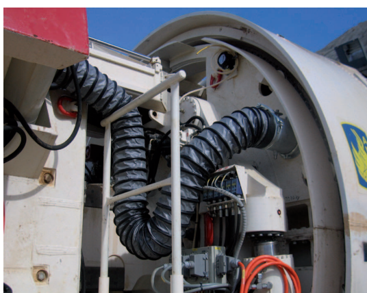
Foto 2 – Condotto di aspirazione polveri.
