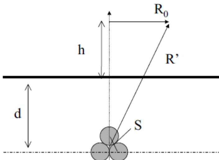
In accordo con la norma CEI 106-11, per la posa in questione, con singola terna di cavi all'interno del cavidotto, si procede applicando la formula semplificata per il calcolo diretto della distanza  $R_0$  dall'asse della linea al livello del suolo ( $h=0$ ) oltre la quale l'induzione magnetica scende al di sotto del valore di  $3 \mu\text{T}$ .
