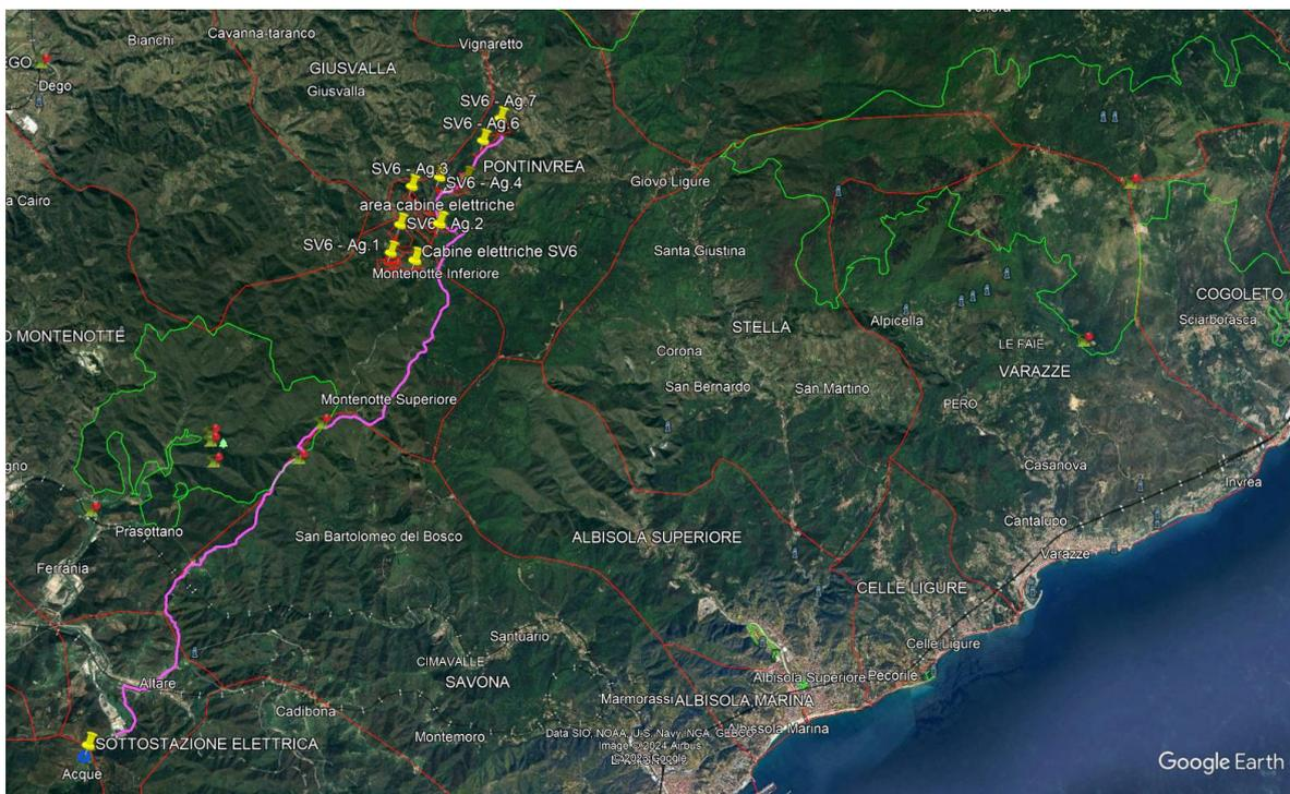
Il percorso cavo interrato di connessione a Terna è definito fino alla futura stazione di Terna prevista ma non ancora ufficializzata a Mallare dove verrà realizzata l'entra esci sulla 380KV della linea Magliano Lapi – Vado Ligure.
