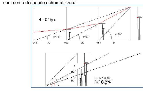
Sempre all'interno delle linee guida del MIBAC viene consigliata un'area MIT (Mappa intervisibilità teorica) pari a 35km per aerogeneratori di altezza superiore a 130mt. Si può quindi concludere che, considerando un raggio di visibilità di 30km, si rimane in una situazione più che cautelativa, rispettando la normativa e, non considerando la vegetazione, le antropizzazioni e il potere visivo dell'occhio umano.
