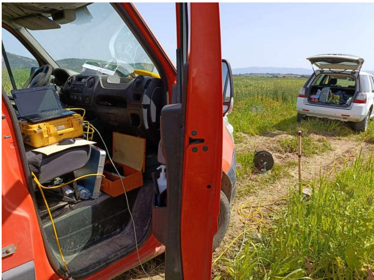
Foto 1 – Stendimento sismico MASW 2 con dettaglio postazione strumentazione (vista verso est).
