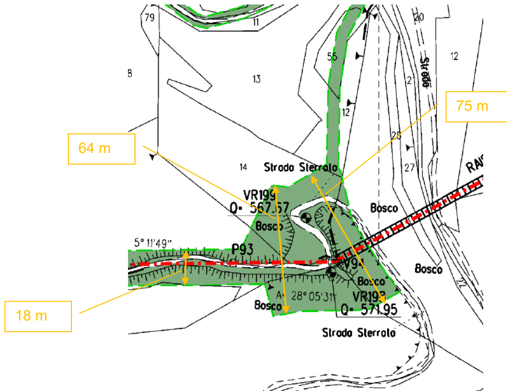
Fig. 2/F: Aree di occupazione lavori interferenti con aree boscate tra P93 e V94+19m (8° Tronco) – cantiere raise boring imbocco sud
