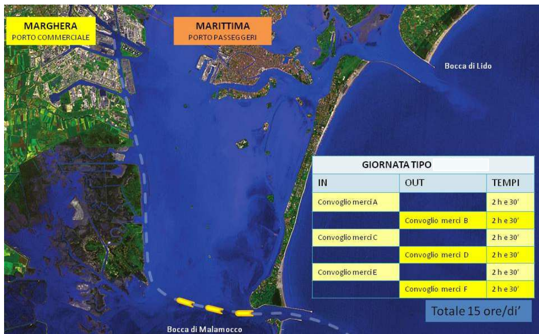
Figura 2: Stima dei tempi di percorrenza di 6 convogli merci/giorno attraverso il Canale Malamocco-Marghera
