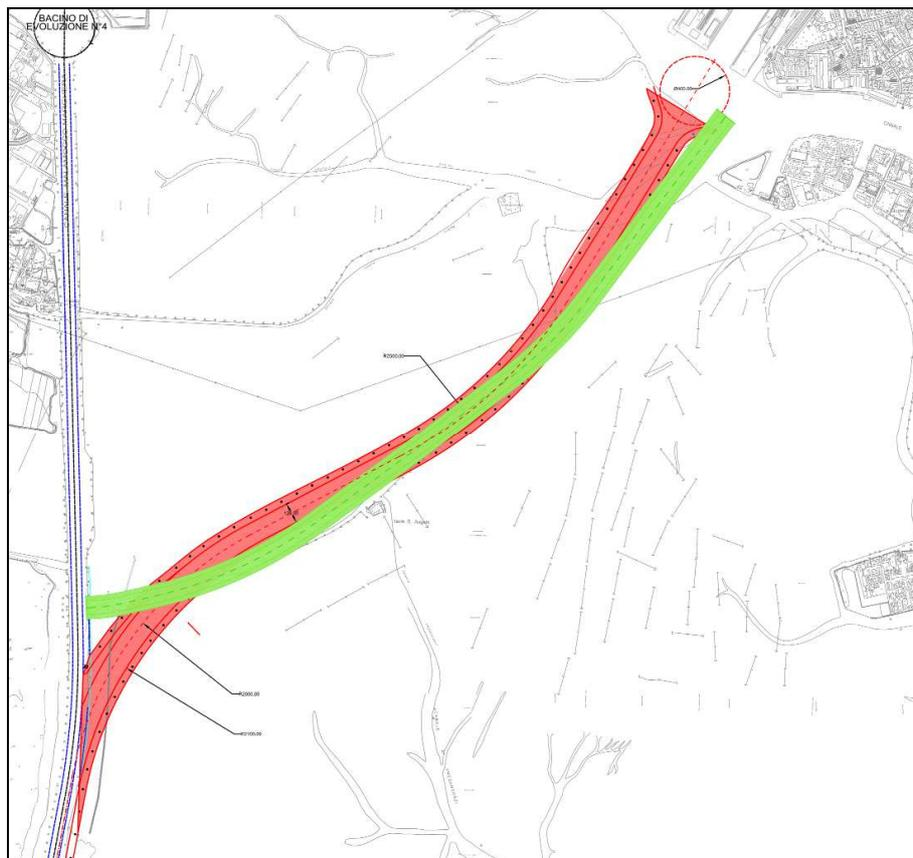
**Figura 2 - Confronto dell'andamento planimetrico della prima configurazione di progetto (in verde) e della seconda configurazione di progetto (in rosso).**
