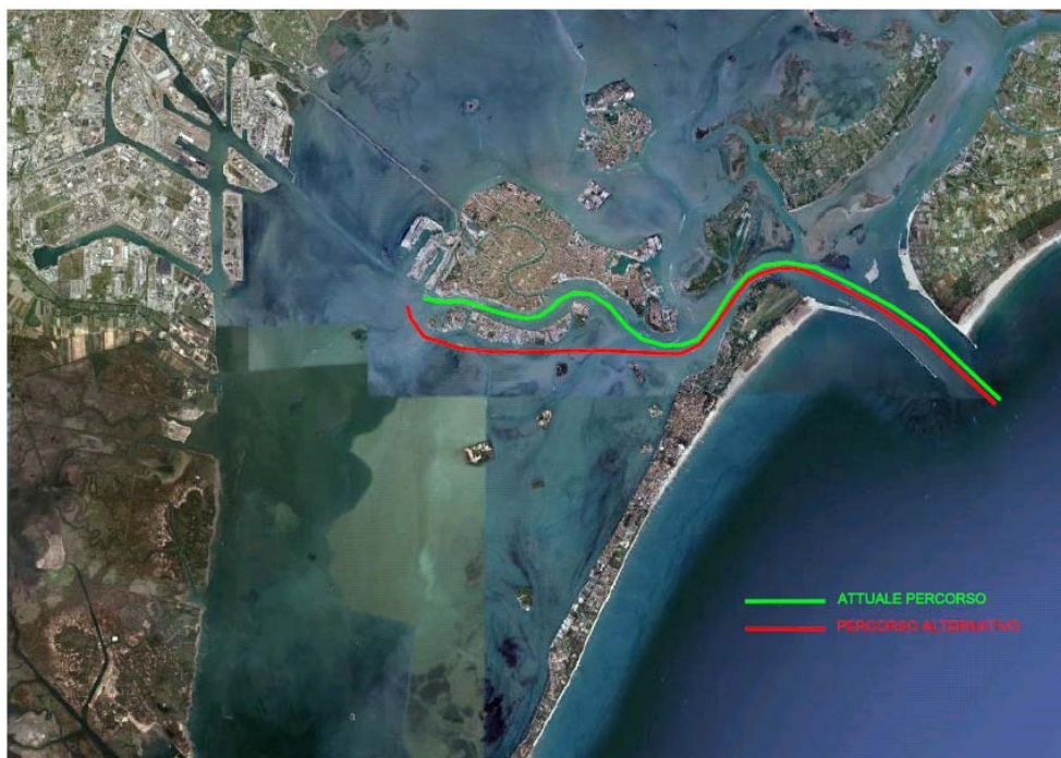
Figura 6.5. Tracciato canale attuale e di progetto
