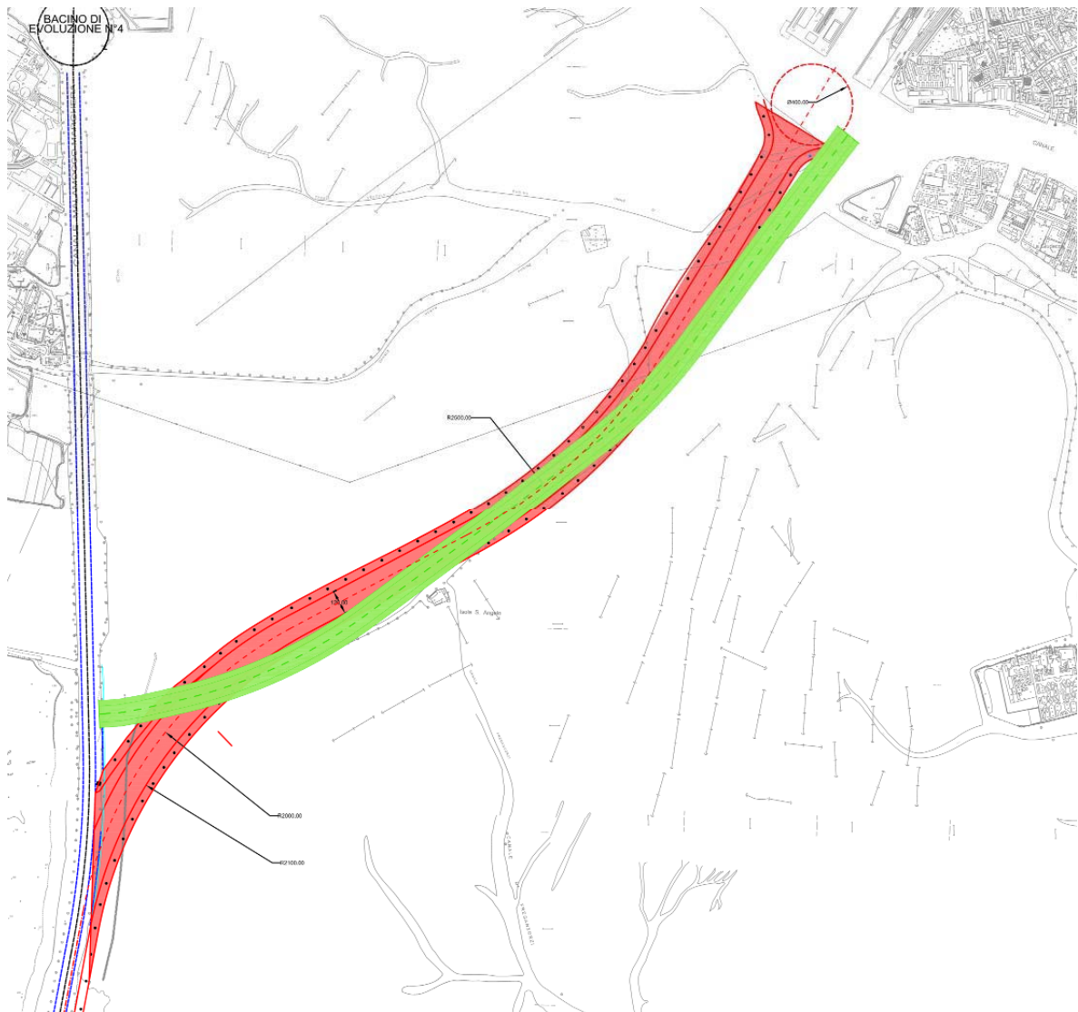
Figura 2.4. Confronto dell'andamento planimetrico della prima configurazione di progetto – Studio di Fattibilità MAV (in verde) e della seconda configurazione di progetto Progetto Preliminare in seguito alle verifiche nautiche (in rosso)
