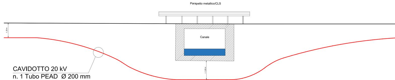
N.B: L' attraversamento sotterraneo dovrà essere effettuato con la tecnica della trivellazione orizzontale controllata (T.O.C.) mediante l'impiego di macchine spingitubo che utilizzano tubi in polietilene ad alta densità (PEAD).
