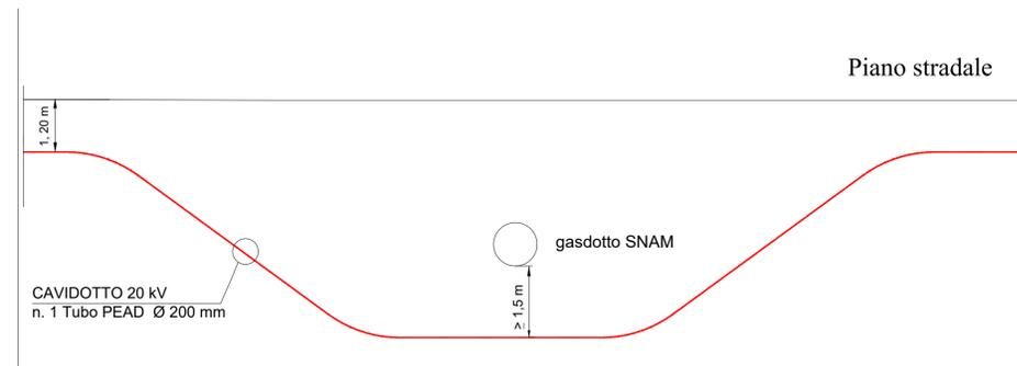
N.B: L' attraversamento sotterraneo dovrà essere effettuato con la tecnica della trivellazione orizzontale controllata (T.O.C.) mediante l'impiego di macchine spingitubo che utilizzano tubi in polietilene ad alta densità (PEAD).
